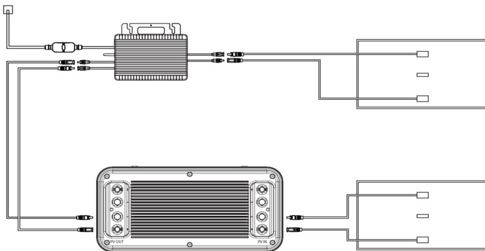
\*Dieses Problem entsteht aus der Tatsache, dass einige der auf dem Markt erhältlichen Mikro-Inverter einen gemeinsamen internen Bezugspunkt haben. Wenn die beiden Mikro-Inverter gleichzeitig an einen Batteriesatz angeschlossen werden, wird der Mikro-Inverter abnorm funktionieren.
