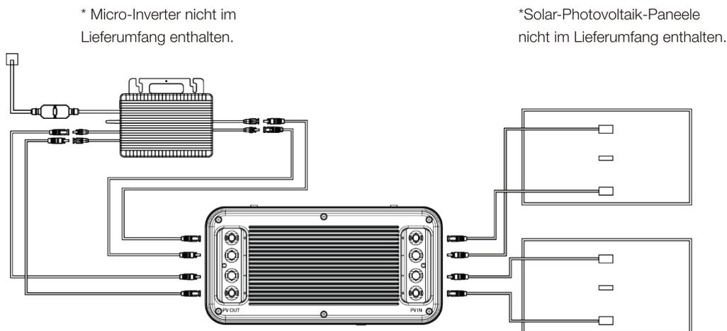
Wenn Sie feststellen, dass der Mikro-Inverter nach der oben beschriebenen Verbindung nicht ordnungsgemäß funktioniert, verbinden Sie bitte auf folgende Weise: Verbinden Sie einen der Mikro-Inverse mit dem Output1 des Produkts, und der andere Mikro-Inverse wird entweder ausgesetzt oder mit der Solarenergie verbunden.
